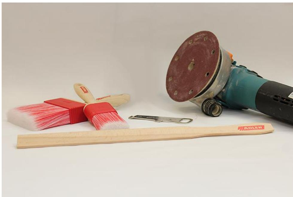
Рекомендуем наносить Lignovit Lasur на чистую, ничем не обработанную древесину. Перед нанесением Lignovit Lasur древесину необходимо отшлифовать шкуркой с зерном 80мкм и прогрунтовать Lignovit IG.
