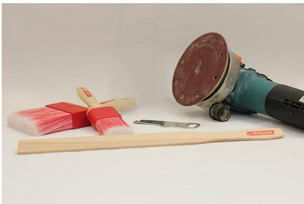
**Подготовка основания: для наружной отделки финишное шлифование шлиф.шкуркой с зерном 80мкм (или 60мкм, чем грубее, тем эффектнее получится покрытие) вдоль волокон.** Обращать внимание, чтобы шкурка была предназначена для шлифования древесины.
